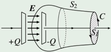
平行板コンデンサーに電流  $I(t)$  が流れている. 閉曲線  $C$  とそれに囲まれた 2 つの面  $S_1$  と  $S_2$  を考える.
