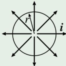
半径  $r$  の球面  $S$  を考える. この内部の電荷を  $Q(r, t)$  とすると, 電流密度は  $i(r, t) = i(r, t)\hat{r}$  と書け,
