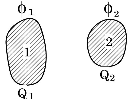
(1)  $\Delta\phi(\mathbf{r}) = 0, \phi(\text{導体 } 1 \text{ の表面}) = \phi_1, \phi(\text{導体 } 2 \text{ の表面}) = 0,$
