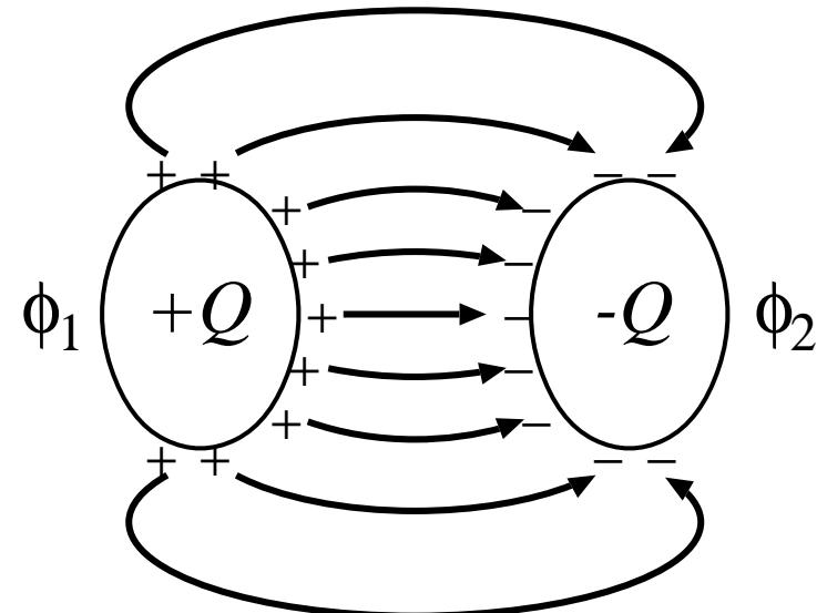
$$(1) \quad C \equiv \frac{Q}{\phi_1 - \phi_2} : \text{静電容量 (電気容量)}$$
