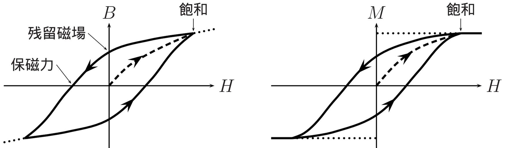
鉄: 残留磁場  $B \sim 0.4 \text{ T}$  , 保磁力  $H \sim 50 \text{ A/m}$
